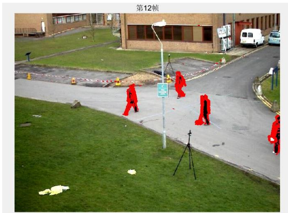
图 2-2 在第 12 帧检测到的运动目标的轮廓
