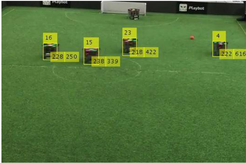
图 4-5 对多个足球机器人的定位效果截图
