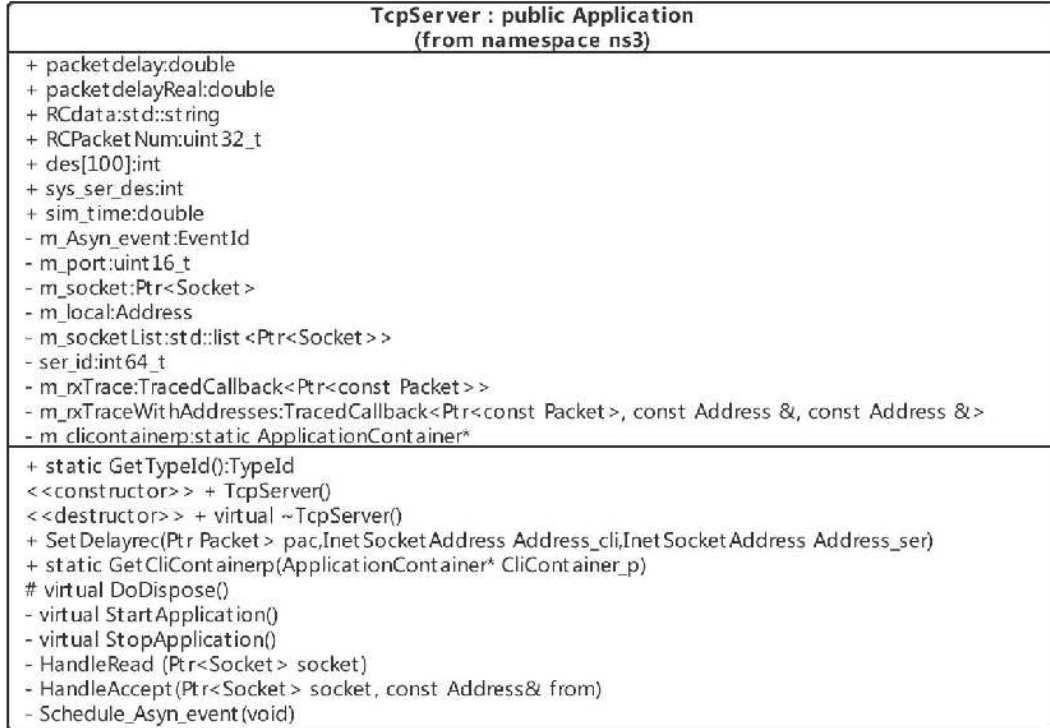
图4-6 TCP服务器应用类UML类图
