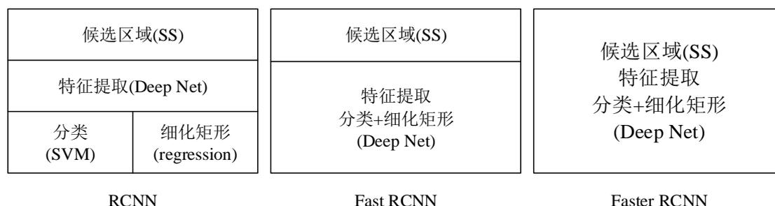
图 1-2 R-CNN、Fast R-CNN、Faster R-CNN 的框架变化
