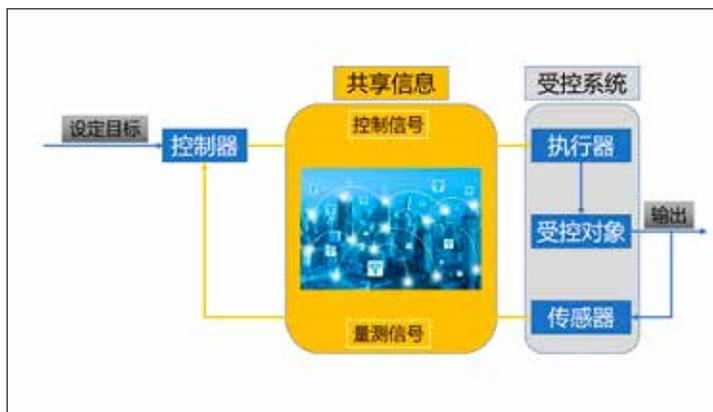
图1 网络化控制系统示意图
