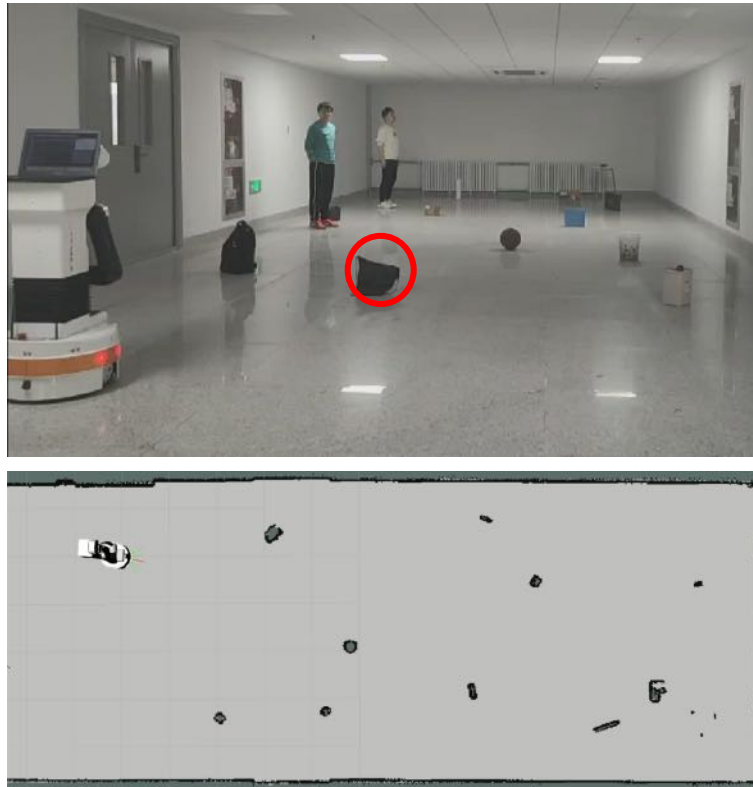
图 5-9 TIAGo 机器人开始采用改进 DWA 进行路径规划
