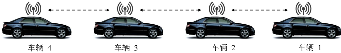
图 2.1 四个车辆组成的多智能体系统, 其中的虚线表示车辆之间的信息传输
