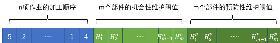
图 4.5 基于阈值的机会性维护和生产调度联合优化模型染色体编码
