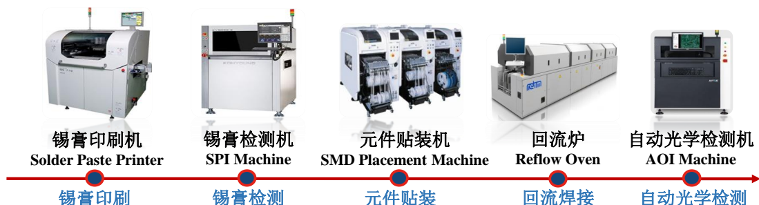
图 1.2 标准 SMT 工艺的主要生产环节
