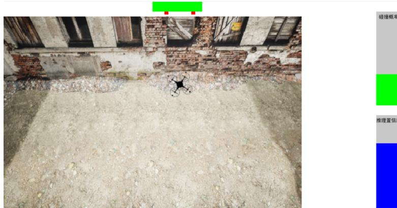
(b) 中透明度  $\tau_m$ ：在界面右侧用绿色和蓝色柱状图分别显示碰撞概率与推理置信度
