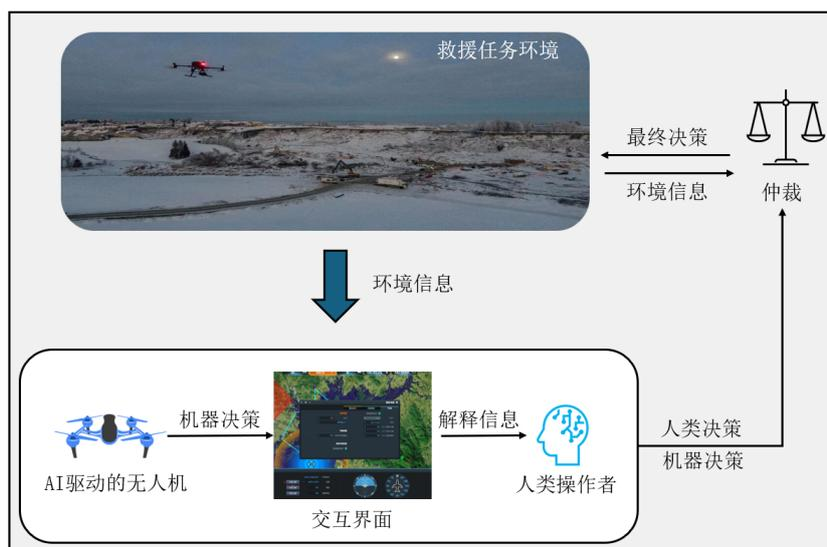
图 4.1 搜救无人机协同控制系统框图
