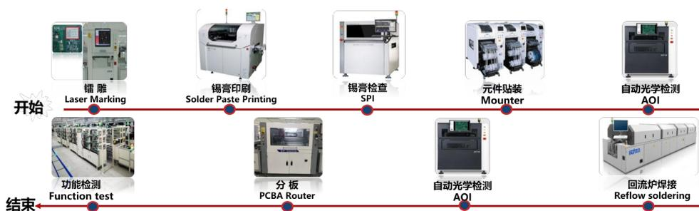
图 1.1 SMT 产线流程
