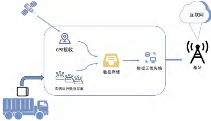
图 3.1 OBD 数据采集终端结构
