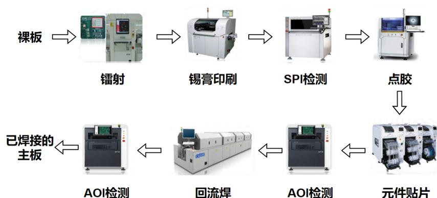
图 2.1 SMT 工艺流程
